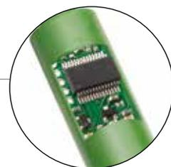
Les nouvelles électrodes conçues pour **edge** sont aussi innovantes que l'instrument lui-même. Munies d'une puce électronique, elles ont en mémoire le type de la sonde, les données d'étalonnage et le numéro de série. Ces informations sont automatiquement transférées sur l'instrument dès leur connexion.
